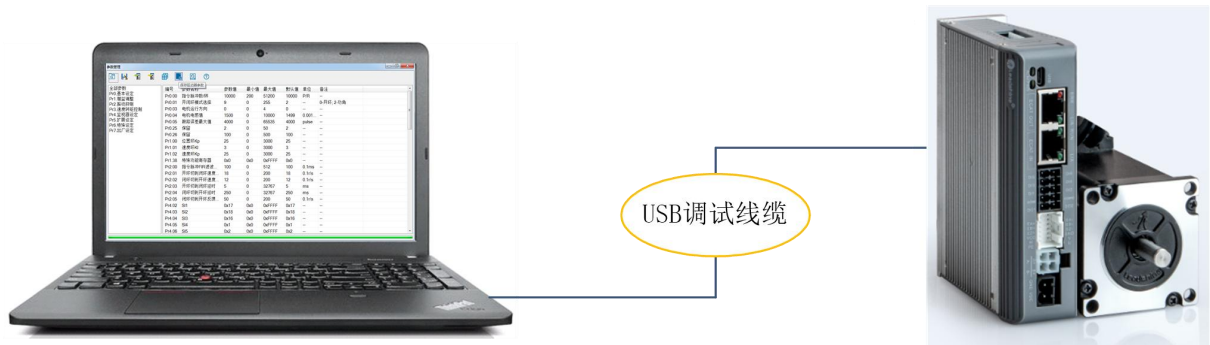
图 4-2 驱动器与 PC 的连接示意图
